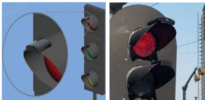
Рис. 2. Расположение устройства SLM на козырьке фонаря
